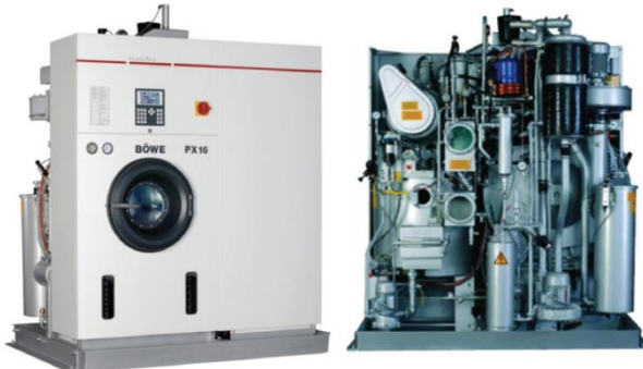
Figura 1 Máquina moderna de lavagem a seco. Fabricada na Alemanha pela Bowe®/Permac, seu processo de limpeza utiliza o percloroetileno como solvente.
