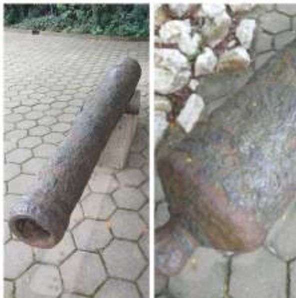
Figura 7 - Detalhes da ferrugem no canhão de guerra, no MBML
