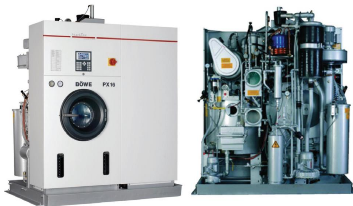
Figura 3. Máquina moderna de lavagem a seco. Fabricada na Alemanha pela Bowe®/Permac, seu processo de limpeza utiliza o percloroetileno como solvente.
